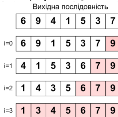
Рисунок 3 - Схема алгоритму сортування обміном
