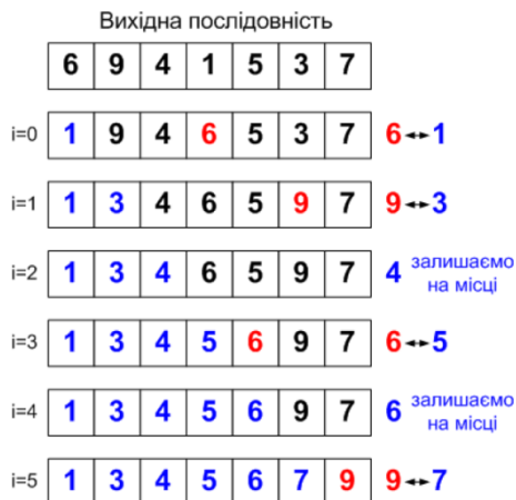
Рисунок 1 - Схема алгоритму сортування вибором
